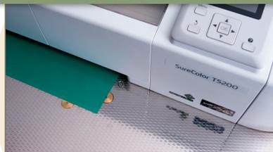
Il faut, en utilisant 4 canaux du traceur EPSON afin d'obtenir la vitesse d'impression la plus élevée, 4 minutes environ pour imprimer une plaque A3 à l'encre noire en 2880 x 2880 dpi. C'est possible à l'aide des technologies brevetées de StudioRIP : Dynamic Density Modulation, Edge Enhancement et Ink Spread Compensation.
