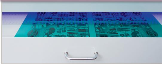
L'encre et le revêtement à jet d'encre sont lavés à l'eau courante, traités avec une développeuse classique, lavés une nouvelle fois et ensuite séchés. Le processeur de plaque semi-automatique, équipé d'un tuyau d'évacuation et relié à l'eau courante et à l'électricité, garantit la propreté de l'eau et la pureté du produit chimique.
