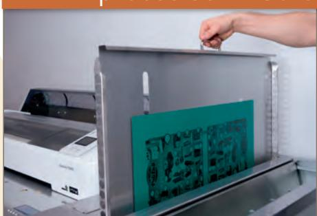
Cerneala și stratul de gelatină se spală cu apă, developarea se face cu soluție convențională de developat, placa se spală încă o dată, iar apoi se pune în uscător. Developerul semi-automat comandă electrovalva de apă, pompele de developare și uscătorul, având grijă ca apa să rămână curată, iar developerul proaspăt.
