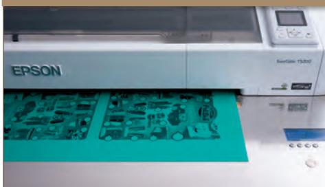
Lucrarea se printează cu cerneală neagră la 2880×2880 dpi în circa 4 minute pentru formatul A3, folosind 4 canale ale imprimantei pentru viteza maximă, utilizând tehnologii brevetate StudioRIP ca Dynamic Density Modulation, Edge Enhancement și Ink Spread Compensation.
